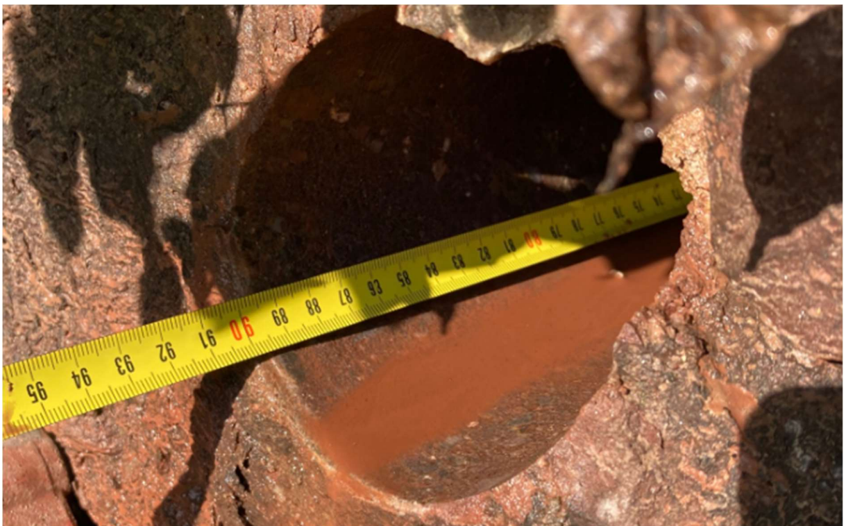
Hloubka vrtu při provrtání skrze celou šířku opěry
