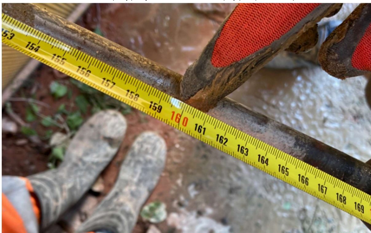
Hloubka vrtu při dosáhnutí úrovně základové spáry
